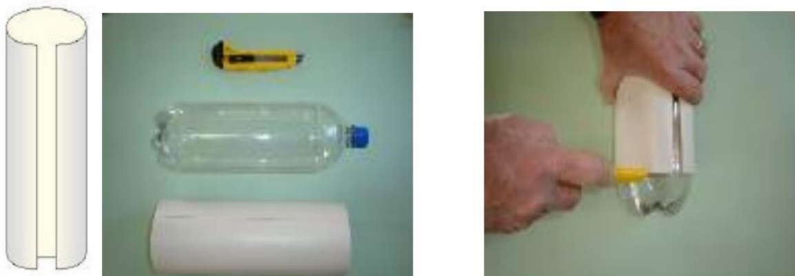
Figura 3 – Corte da garrafa PET e encaixe do tubo PVC.
